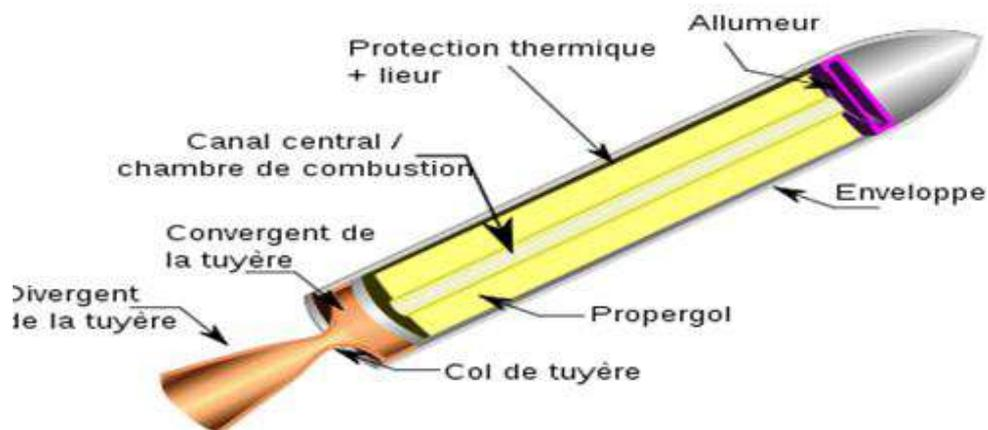
Schéma d'un propulseur à propergol solide
