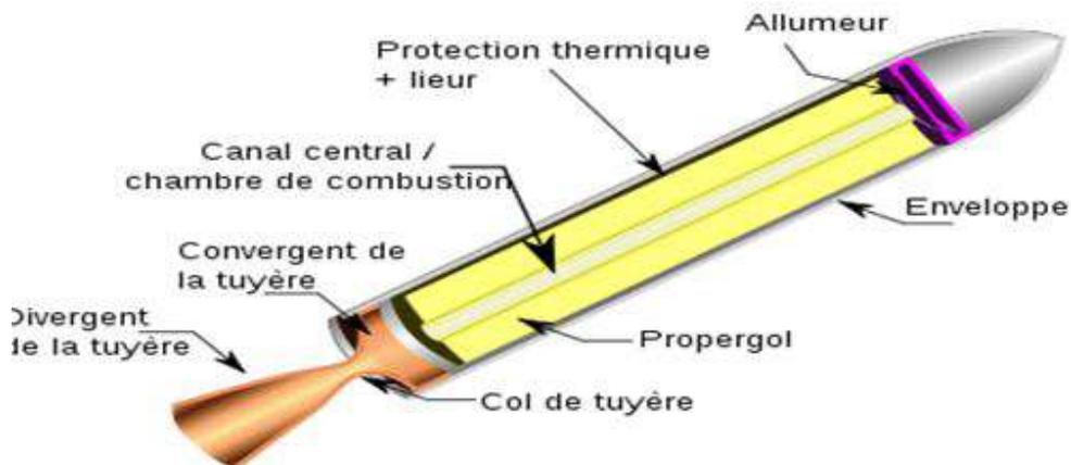
Schéma d'un propulseur à propergol solide
