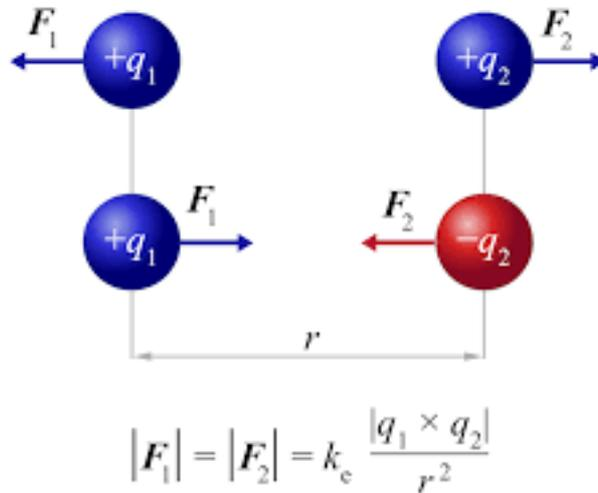
La loi de Coulomb exprime, en électrostatique, la force de l'interaction électrique entre deux particules chargées électriquement.
