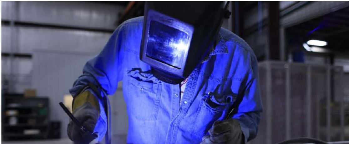
En industrie, une Cagoule est une protection faciale utilisée pour la Soudure.
