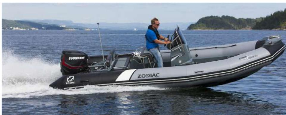
Le Zodiac a la particularité d'avoir une flottabilité, une stabilité, un poids et une capacité de charge en poids et passagers supérieurs à un bateau rigide de mêmes dimensions.
